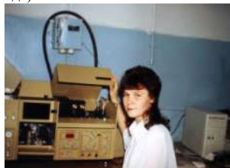
атомно-абсорбционный спектрофотометр «Квант-АФА»
